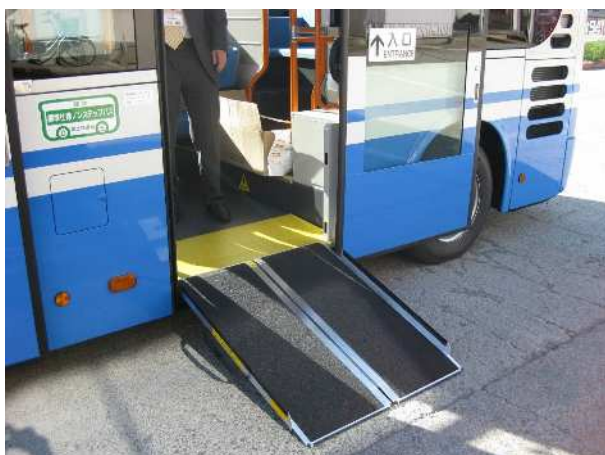
写真 3-1-3 車椅子用スロープ
